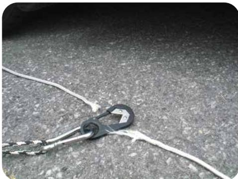
*La sogá tira del CUTABINER™ de forma segura y corta el cable remotamente*
