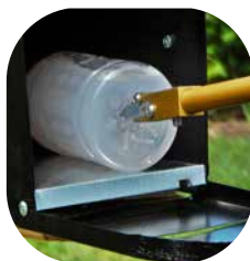
perforador de botellas Punta con diseño de cuchilla doble para perforar botellas con líquidos desconocidos.
