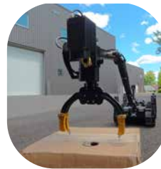
Abridor de cajas Juego de dos cuchillas en las puntas de la pinza. Abra cajas de forma rápida y sistemática
